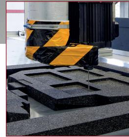
Auf unseren CNC - Fräsmaschinen werden die entwickelten Bauteile gefräst. Mit den so gewonnenen 1:1 Modellen kann das Design geprüft werden, bevor das Serienwerkzeug erstellt wird. Der Verfahrensweg von 2500 mm x 1350 mm x 400 mm ermöglicht die Umsetzung nahezu jeglichen Prototyps aus EPP, EPS, EPE, E-TPU und PIOCELAN. Mit diesen Programmen (CAD Software Catia V5, Inventor 2017, Solid Works und Siemens NX) kann die Konstruktion erfolgen und auf den CNC - Anlagen die Prototypen erstellt werden.
