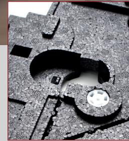
Einbringen von Kunststoff-Inserts, um Verbindungen zu realisieren.
